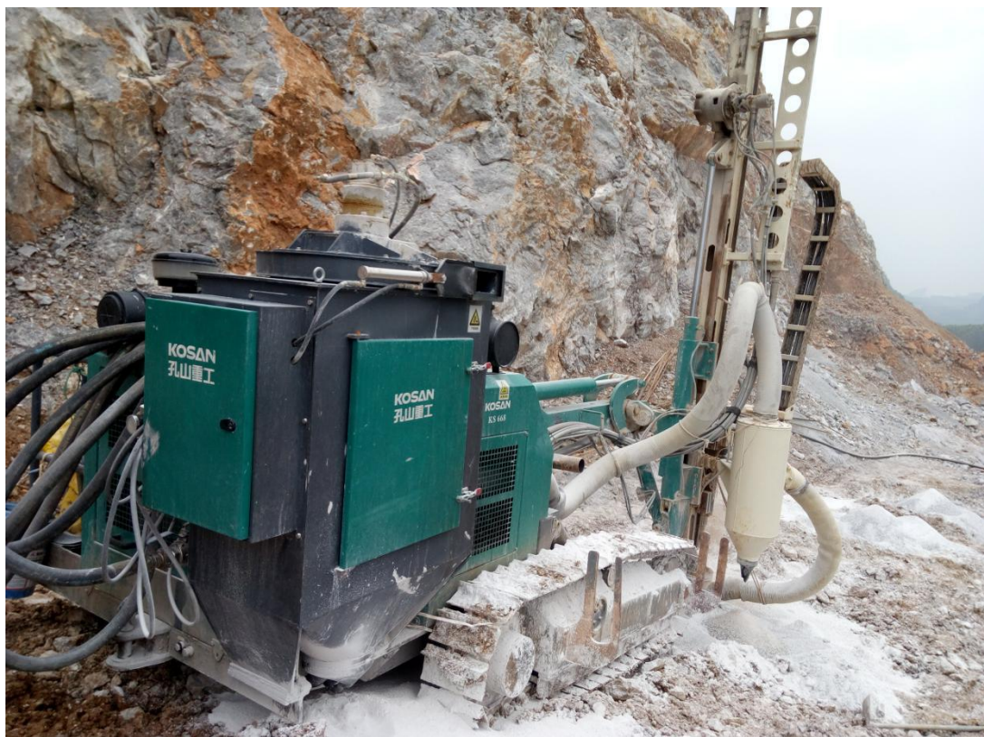
履带式液压潜孔钻机及除尘措施
