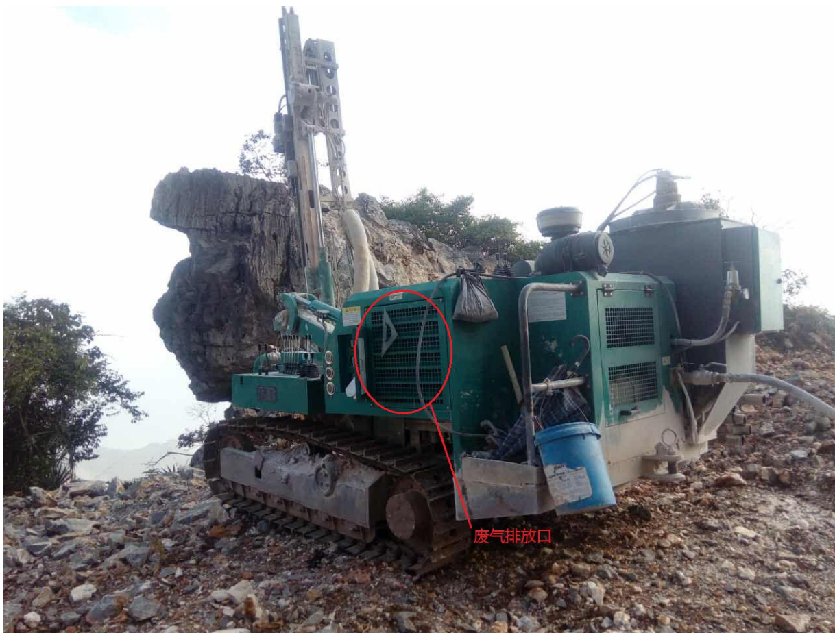
履带式液压潜孔钻机及废气排放口
