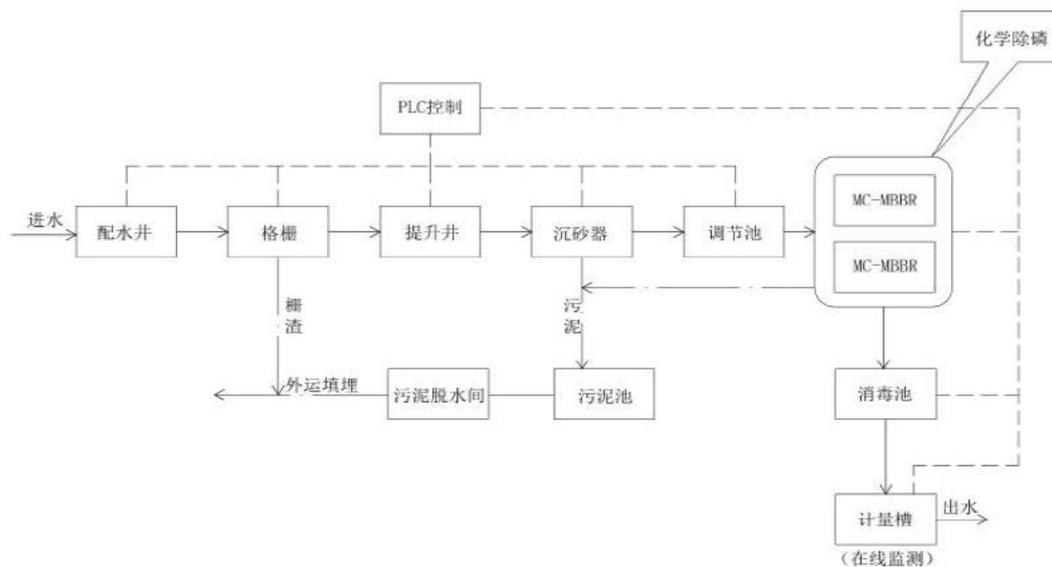
图 2-1 工艺流程及产污环节图
