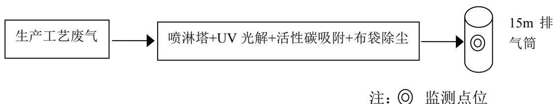
图 3-1 车间有组织废气处理流程图及监测点位图
