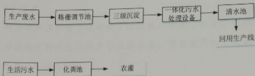
图 3-1 废水处理流程图
