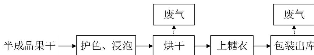
图2-1 生产工艺流程及产污节点图
